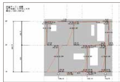
図7 地震荷重時応力図出力例
